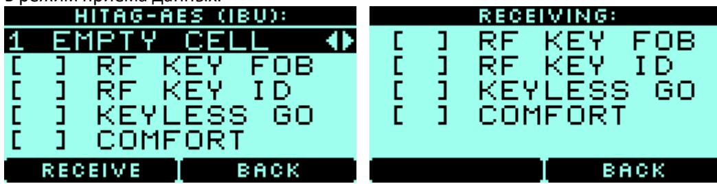
3. Нажмите кнопку **ОТКРЫТЬ** или **ЗАКРЫТЬ** на брелоке. После получения радиосигнала на экране появится **[ + ]** в полях **RF KEY FOB** и **RF KEY ID**.
